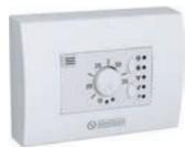
B0151 | <b>Kit comando a parete</b> con termostato, selettore estate/inverno e selettore velocità.<br>Termostato a parete con sonda ambiente, selettore On-Off, selettore a tre velocità ventilatore e selettore estate/inverno. Campo di regolazione temperatura da 5°C a 30°C. Alimentazione a 230 V. Dispone di due uscite 230VAC elettrovalvola acqua calda ed elettrovalvola acqua fredda e di un ingresso sonda temperatura acqua.
