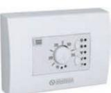
B0151<br>A ESAURIMENTO | <b>Kit comando a parete</b> con termostato, selettore estate/inverno e selettore velocità.<br>Termostato a parete con sonda ambiente, selettore On-Off, selettore a tre velocità ventilatore e selettore estate/inverno. Campo di regolazione temperatura da 5°C a 30°C. Alimentazione a 230 V. Dispone di due uscite 230VAC elettrovalvola acqua calda ed elettrovalvola acqua fredda e di un ingresso sonda temperatura acqua.
