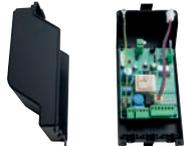
B0756 | Kit comando <b>per remotizzazione</b> per la gestione e il controllo tramite ingresso analogico 0-10V o contatti. Dispone di un uscita a 230VAC per il controllo di un'elettrovalvola e di un ingresso sonda acqua con funzione sonda di minima (nella modalità a contatti).
