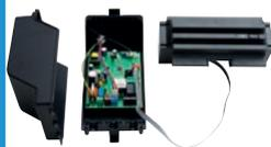
B0685  | Kit comando Bi2 Inverter <b>per remotizzazione</b> .<br>I principali parametri operativi, il set point e la temperatura ambiente, vengono trasmessi dal controllo remoto B0736 a tutti i fancoil connessi in rete, consentendo un funzionamento omogeneo. Dispone di un'uscita a 230VAC per il controllo di un'elettrovalvola, di due contatti puliti per il comando boiler o chiller e di un ingresso presenza.<br>Funzionamento in protocollo MODBUS, RS485.
