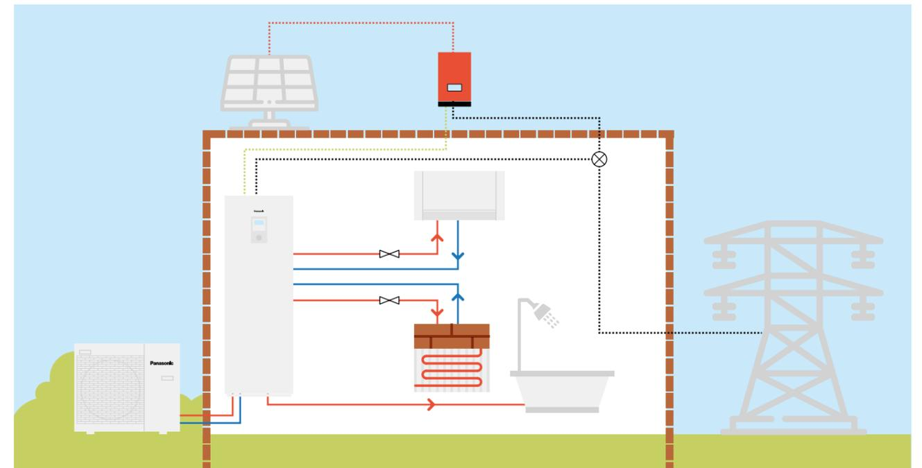
Le pompe di calore Aquarea sono progettate pensando al futuro. E' possibile sincronizzare le pompe di calore con i pannelli fotovoltaici utilizzando una scheda PCB CZ-NS4P per funzioni aggiuntive. Grazie a questa opzione, la domanda di riscaldamento, raffreddamento e produzione di acqua
